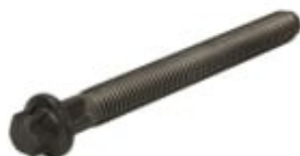
Skrutka hlavy valcov závit M14, dĺžka 141,00 mm, DEUTZ
