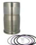
Vložka válcov vnútorný priemer 131,00 mm, dĺžka 262,00 mm, RENAULT, VOLVO
